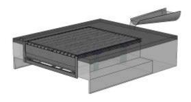
D. Placer le niveleur au ras du quai. Il n'est pas nécessaire de souder. Procéder avec la coulée finale du sol industriel. L'installation est terminée.
