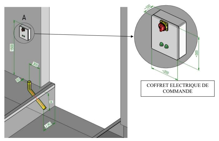
Dans le cas où n'est pas possible de positionner le fourreau de passage câble dans le point indiqué sur notre plan, on peut utiliser des cotes alternatives, dépendant du modèle de niveleur et de ces dimensions, selon la fiche suivante :
