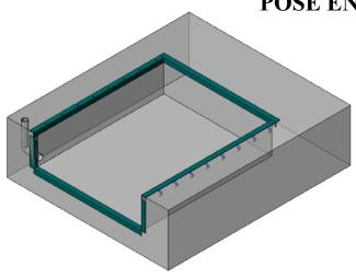
A. La fosse est réalisée parfaitement carrée ainsi que ses parois doivent être lisses et bien agrémentées. Le long du rebord, il faut placer une cornière ayant fonction de "sauvecoin".
