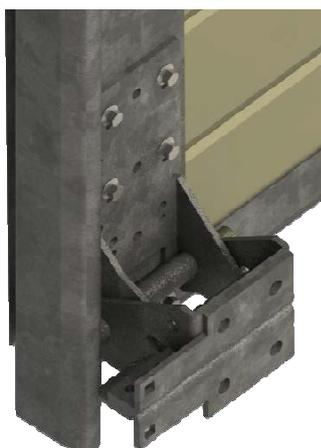
In caso di allentamento della fune, la lamina d'acciaio temperato si pianta sulle guide bloccando la discesa del portone.
